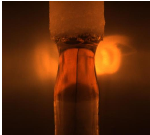
Crecimiento de un cristal de \text{Li}_6\text{Eu}(\text{BO}_3)_3 por fusion de zona vertical en un horno a calentamiento óptico ( R. Belhoucif/M. Velazquez – ICMCB ).
