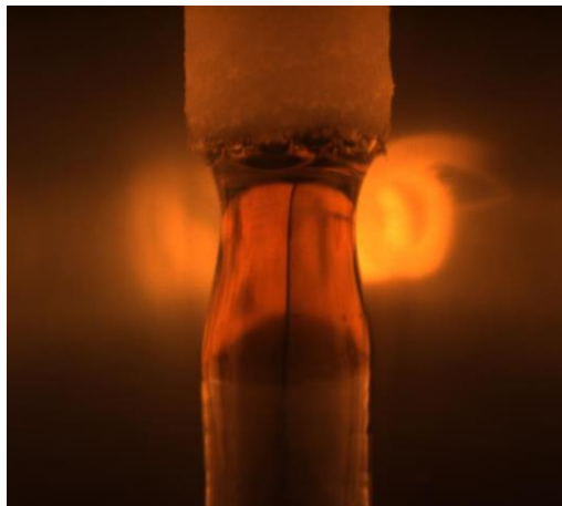
Crecimiento de un cristal de \text{Li}_6\text{Eu}(\text{BO}_3)_3 por fusión de zona vertical en un horno a calentamiento óptico (R. Belhoucif/M. Velazquez – ICMCB).
