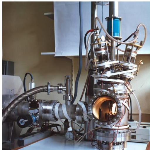
Horno "Tri-arcs" para experimentos de crecimiento de cristales por el método Czochralski.
