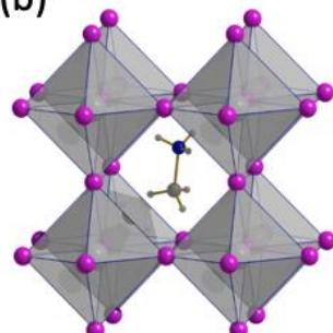
Figure 1: Structure of (a)  $(C_6H_5CH_2NH_3)_2[PbCl_4]$  and (b)  $(CH_3NH_3)PbI_3$ .
