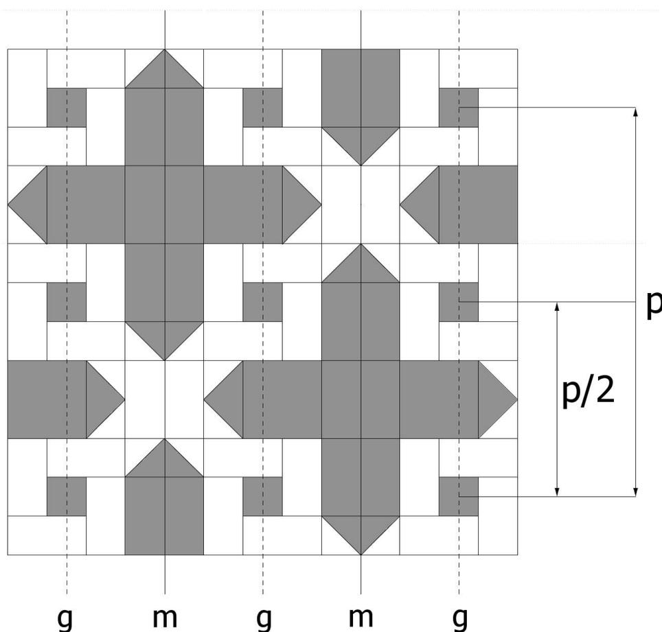
Figure 2 Les plans de symétrie, miroir simple m et miroir avec glissement g
